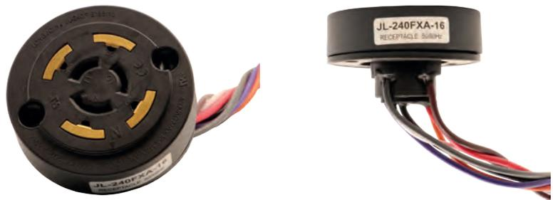
La base 7 pines está configurada con 3 conductores estándar más 4 adicionales fabricados en cobre, dos de ellos para efectos de control en la atenuación de color violeta y gris, y dos adicionales sin conectar para efectos de monitoreo y sensores.
