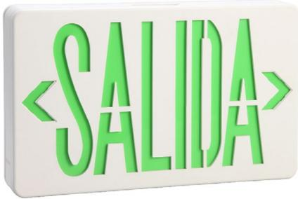
Luminaria LED multi-voltaje tipo rótulo para salidas de emergencia en color verde con indicador de carga, botón de prueba y batería sellada de Níquel - Cadmio. Su cuerpo es de material ignífugo en plástico inyectado.
